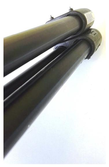
En cada pozo, se introdujo un intercambiador geotérmico de PE100-PN16 en doble-U de 32 mm de diámetro, siendo rellenados convenientemente mediante la inyección de un cemento bentonítico.
